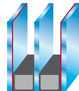
3-fach Isolierglas mit zwei unsichtbaren Wärmedämmbeschichtungen aus Edelmetall.
